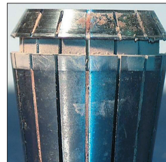
Stark verschmutzte Spannzange
